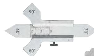
**Esecuzione per il controllo delle saldature su parti saldate ad angolo retto**
